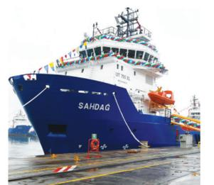
Обновлены системы связи и электрорадионавигационное оборудование, заменены неисправные детали. Установлено современное оборудование для измерения скорости. Кроме того, надводная часть судна очищена и окрашена, а жилые и служебные помещения для моряков приведены в соответствие с современными стандартами. Длина судна составляет 154,5 метра, ширина - 18,3 метра, максимальная скорость - 12,5 узлов.
